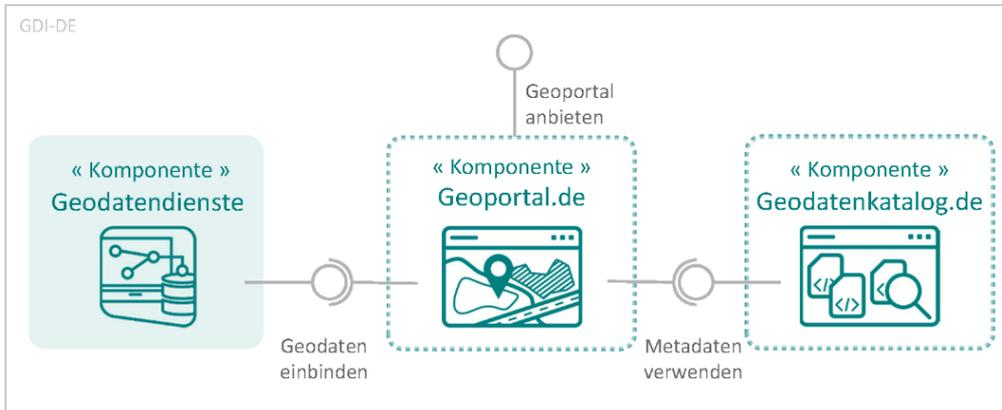
Abbildung 13: Komponentendiagramm Geoportal.de
