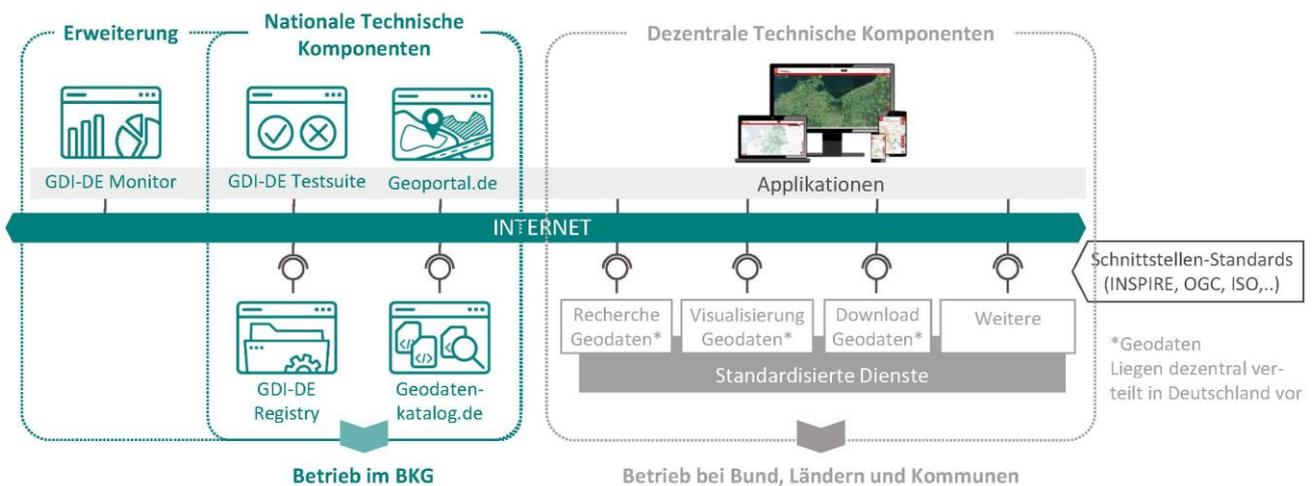
Abbildung 4: Schematische Darstellung der Architektur der GDI-DE
