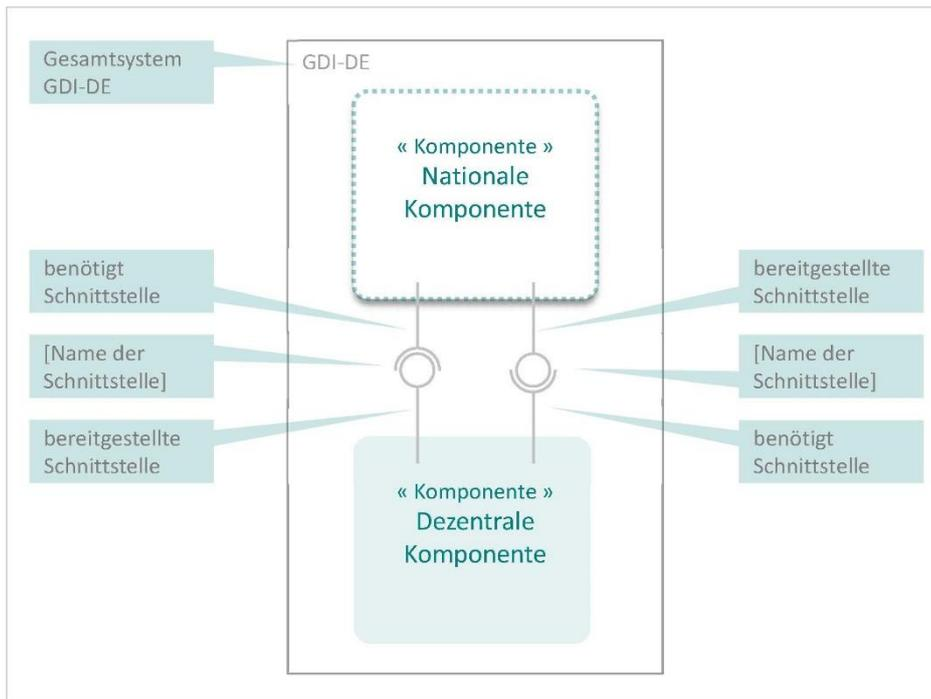
Abbildung 10: Beziehungen zwischen einer nationalen und dezentralen Komponente
