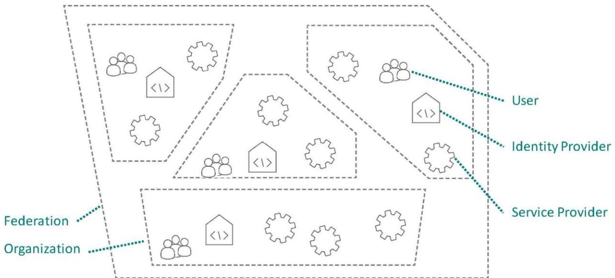
Abbildung 9: Schematische Abbildung einer Authentifizierungs- und Autorisierungsinfrastruktur (AAI)
