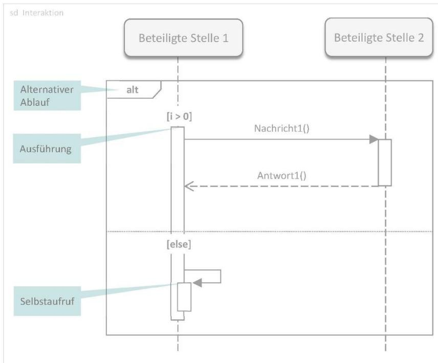
Abbildung 18: UML Sequenzdiagramm zur Beschreibung von Interaktionen
